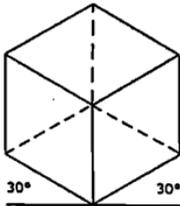
Die Isometrie ist eine Form der Parallelperspektive, die häufig bei technischen Zeichnungen angewendet wird. Der Körper wird überrück dargestellt, wobei die in die Tiefe führenden Linien zur Waagrechten in einem Winkel von  $30^\circ$  verlaufen.
