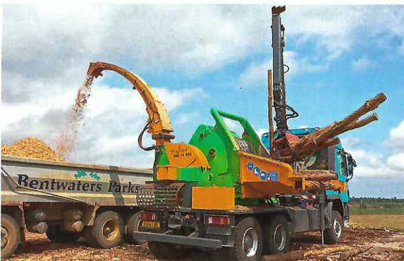
►1 Holzschredder im Einsatz
